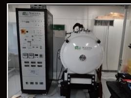
学内の熱真空試験設備を用いて、熱真空試験手法について学ぶ。特に銀テフロンや多層断熱材(MLI)など熱制御材の特性評価を行い、宇宙における熱の伝わり方や熱設計の考え方について理解を深める。
