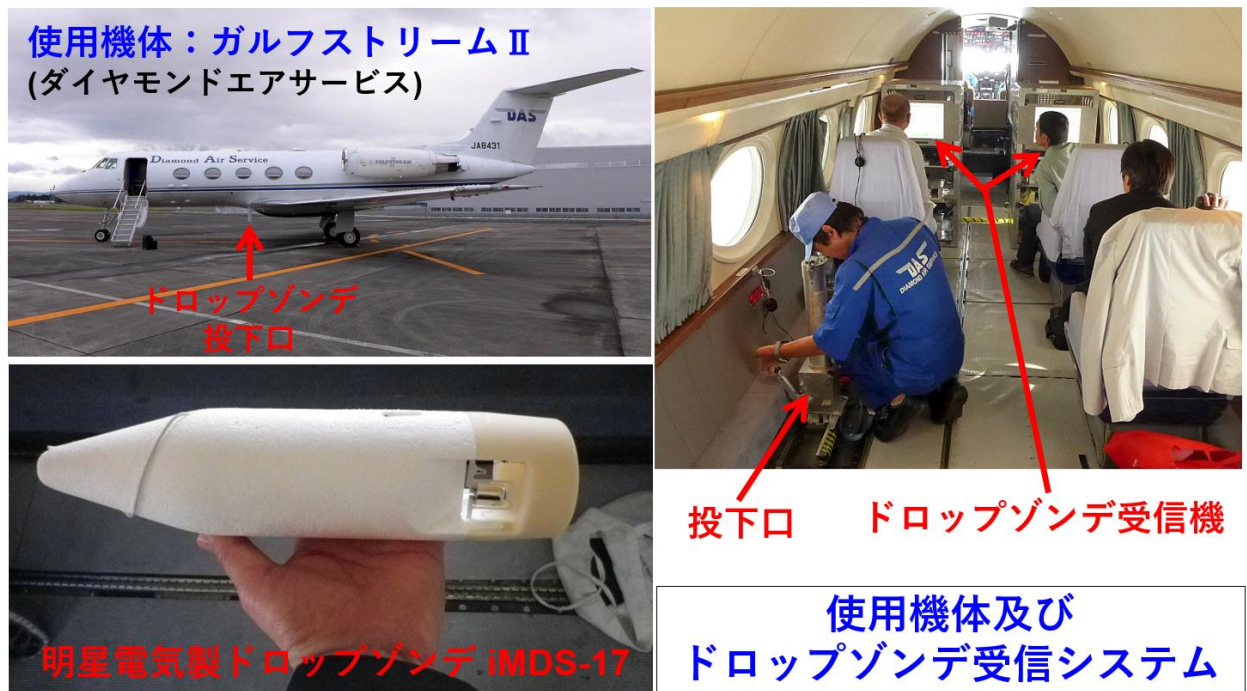
図1 (左上) 航空機観測に使用したダイヤモンドエアサービス株式会社のガルフストリームII。(左下) 本研究で航空機から投下したドロップゾンデと呼ばれる観測機器。観測したデータを電波で航空機に送る。(右上) 観測を行った際の機内の様子。
